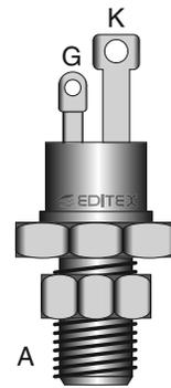
Figura 7.32. Identificación de los terminales de un tiristor de potencia.
